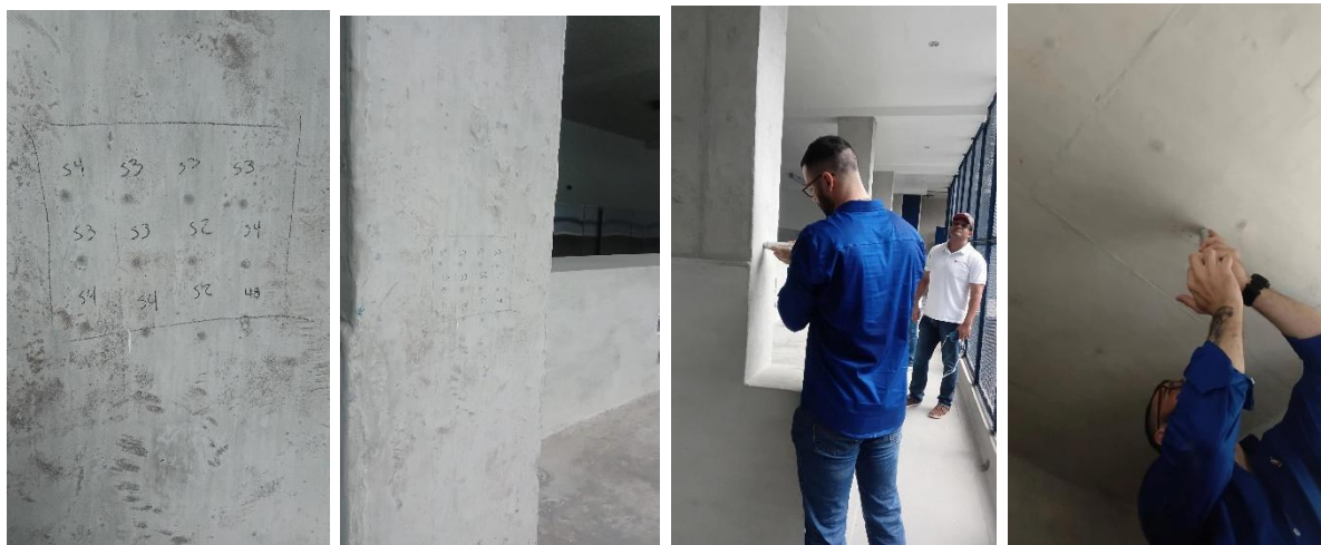
Figura 1.10. Registro fotográfico ensayo de esclerómetro. Registro fotográfico de ensayo de esclerómetro estructura 222-2023 pabellón de mujeres.
