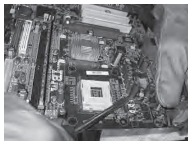
Ilustración 77: Desmontar un condensador. Foto: MAVDT
