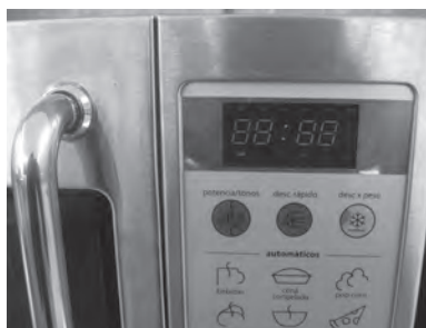
Ilustración 72: LCD en un microondas. Foto: MAVDT
