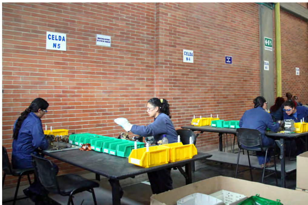
Operarios realizando procesos de demanufactura y segregación de materiales en una planta de gestión de RAEE.
