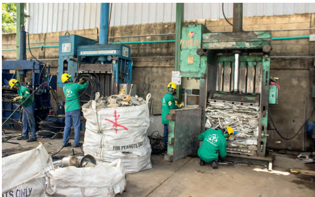
Procesos mecanizados de recuperación de materiales procedentes de los RAEE.
